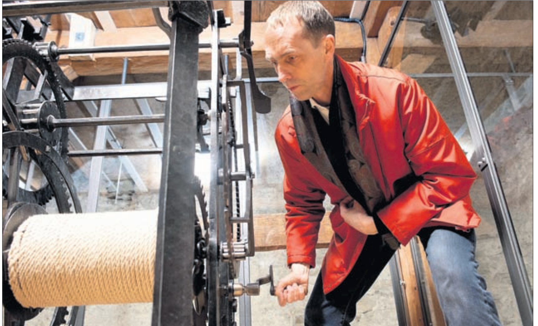
Uhrmacher Martin Spöring zieht mit einer Kurbel die grosse Uhr im Luzerner Zyturm auf.
